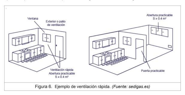
Cuando por razones constructivas un local, que debiendo disponer de ventilación rápida por albergar aparatos de tipo A [o tipo B] no pueda disponer de tal ventilación rápida, se
