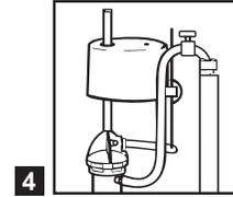
**4** Conecte un extremo de la manguera de llenado del espejo de agua en el pivote de la válvula de admisión y el otro extremo en el interior del tubo de llenado. Para controlar el flujo de agua hacia el espejo de agua del sanitario apriete o afloje el tornillo hasta lograr la cantidad de agua deseada. Fig 6
