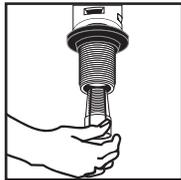
Nunca retire el filtro instalado en la parte inferior de la válvula ya que evita el paso de impurezas.
