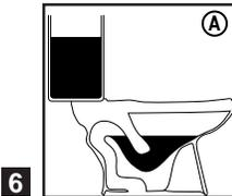
**6** \*\*Para regular el nivel del espejo de agua será necesario hacer varias pruebas, usando la válvula ahorradora, de tal modo que el tanque y el espejo de agua del sanitario lleguen a su nivel ideal al mismo tiempo (fig.A), evitando así que el agua se desborde y se desperdicie cuando el espejo se llene antes que el tanque (fig.B), o que el agua del espejo del sanitario quede muy abajo (fig.C).
