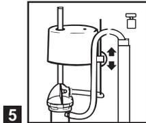
**5** Ajuste el nivel de agua del tanque deseado deslizando hacia arriba o hacia abajo el clip de ajuste de flotador.
