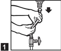
**1** Cierre el suministro de agua y desconecte el Conector Flexible. Vacíe el tanque del sanitario. Seque perfectamente con una esponja.
