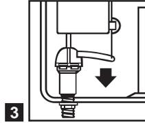
**3** Coloque la válvula de admisión con el empaque en el tanque; por el exterior apriete con la tuerca de sujeción. Instale un Conector Flexible de alimentación de agua a la válvula de admisión.
