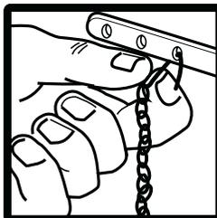
5) Si al momento de accionar la palanca la pera no se mantiene abierta mientras se descarga el tanque, deberá de ajustar un poco la cadena.
