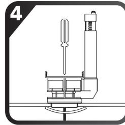
Tome la base (con el empaque) e inserte cuidadosamente el ancla dentro del orificio del tanque inclinando hacia un lado, siempre cuidando que el herraje permanezca unido a la base. Dirija el tubo rebosadero hacia atrás y apriete el tornillo, cuidando que la base quede bien centrada y firmemente unida al orificio del tanque.
