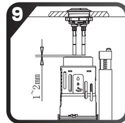
Remueva la tuerca del botón de presión, e instale el botón de presión en la tapa del tanque. Ajuste nuevamente con la tuerca.
