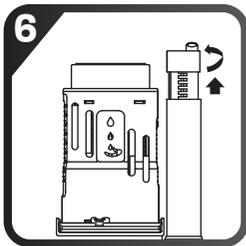
Para Ajustar el Tubo de Rebosadero, gire el tubo interior ajustable en contra de las manecillas del reloj. Jale el tubo hacia arriba o hacia abajo hasta ajustar a una altura de 2 cm. arriba del nivel crítico de agua marcado en su tanque. Gire el tubo interior ajustable a favor de las manecillas del reloj, para fijarlo. Inserte la manguera de llenado de la válvula de admisión en el orificio del tope superior del tubo rebosadero. Asegure que la manguera no esté por debajo del nivel del agua.
