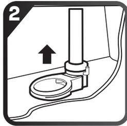
Retire la válvula actual de descarga aflojando el tornillo central de la válvula de descarga.
