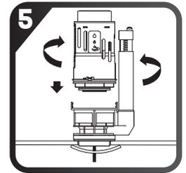
Inserte el cuerpo de la válvula sobre la base recién instalada hasta hacer click. Asegúrese que el cuerpo de la válvula pueda girar libremente.
