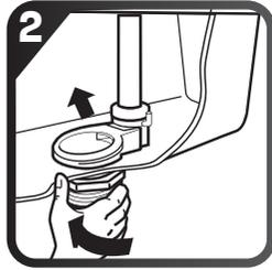
Afloje las tuercas que sujetan el tanque con la taza por la parte inferior.
