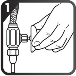
Cierre la llave de suministro de agua del sanitario, vacíe el agua, y seque muy bien el tanque con un trapo o esponja. Retire el Conector Flexible de la válvula de llenado.
