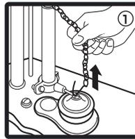
Retire la cadena de la manivela que va a reemplazar.
