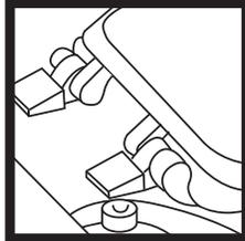
Alinie las bisagras con el sanitario, inserte los tornillos y apriete las tuercas
