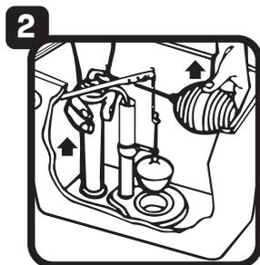
2 Retire la válvula que va a sustituir, incluyendo el flotador y la manguera de llenado del espejo de agua.
