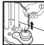
1 Retire la cadena de la manivela que va a reemplazar.
