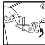
2 Desatornille la tuerca que asegura la manivela al tanque sanitario y retirela. Introduzca la nueva manivela y apriete la tuerca manualmente. En caso de ser necesario utilizar una llave inglesa ajustable. Apretar en exceso puede dañar el producto.
