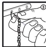
3 Ajuste el largo de la cadena de modo que quede casi justa para asegurar una buena descarga.
