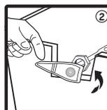
Desatornille la tuerca que asegura la manivela al tanque sanitario y retirela. Introduzca la nueva manivela y apriete la tuerca manualmente. En caso de ser necesario utilizar una llave inglesa ajustable. Apretar en exceso puede dañar el producto.
