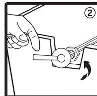
Desatornille la tuerca que asegura la manivela al tanque sanitario y retirela. Introduzca la nueva manivela y apriete la tuerca manualmente. En caso de ser necesario utilizar una llave inglesa ajustable. Apretar en exceso puede dañar el producto.
