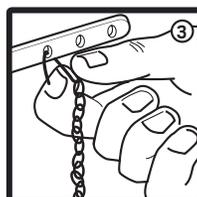
Ajuste el largo de la cadena de modo que quede casi justa para asegurar una buena descarga.
