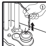
Retire la cadena de la manivela que va a reemplazar.
