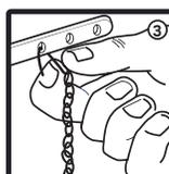
Ajuste el largo de la cadena de modo que quede casi justa para asegurar una buena descarga.
