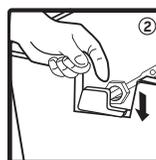
Desatornille la tuerca que asegura la manivela lateral al tanque sanitario y retírela. Introduzca la nueva manivela y apriete la tuerca manualmente. En caso de ser necesario utilizar una llave inglesa ajustable. Apretar en exceso puede dañar el producto.
